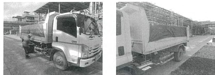
การปิดคลุมรถบรรทุกวัสดุก่อสร้างในการขนส่ง
